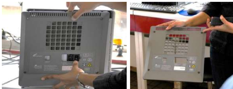
Gambar 6.6 Cara melepas bagian penutup belakang dan filter debu (filter di dalam alat)
