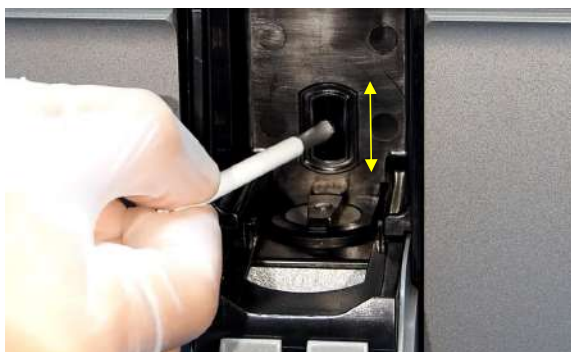
Gambar 6.16 Cara menyikat slot I-core dengan sikat I-core
