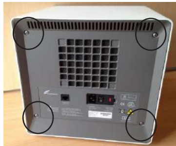
Gambar 6.5 Bagian belakang alat dengan empat baut pengencang
